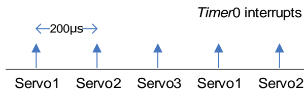
Fig. 3.19: Multiplexagem na leitura dos servos.
