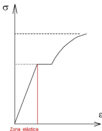
Fig. 4.2: Relação entre força imposta e deformação elástica.
