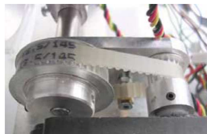
Fig. 3.7: Correia de transmissão aplicada a um servo.
